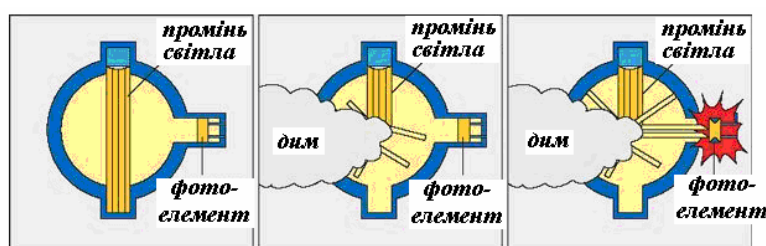
Рис 1. Схема детекторного сповіщувача диму
